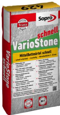
Zementärer, schnell erhärtender, flexibler, trasshaltiger Mittelbettmörtel, C2 FE nach DIN EN 12004, für Mörtelbettdicken von 5 - 20 mm. Zum Verlegen von Fliesen und Platten, Cotto, Naturstein, Betonwerkstein und keramischen Belagsbaustoffen, insbesondere mit großen Dickentoleranzen. Geeignet auf Fußbodenheizungen. Die schnelle Erhärtung wirkt der Verschüsselungsgefahr von kritischen Belagsstoffen entgegen. Verbesserte Verformungseigenschaften mit Sopro megaFlex Dispersion.
