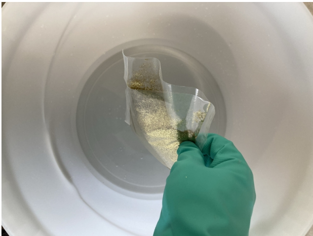
Nach vorsichtigem Aufschneiden des Beutels wird der Glitter in das Anmachwasser gegeben.
